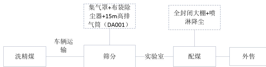
附图 2-5 洗精煤筛分产污及工艺流程图
